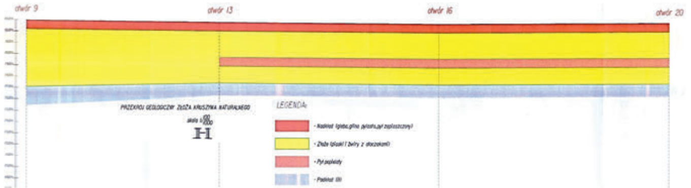
Fot. 6. Przekrój geologiczny przez środkową część złoża kruszywa naturalnego Fot. 6. The geological cross-section (the middle part of a natural aggregate deposit)
