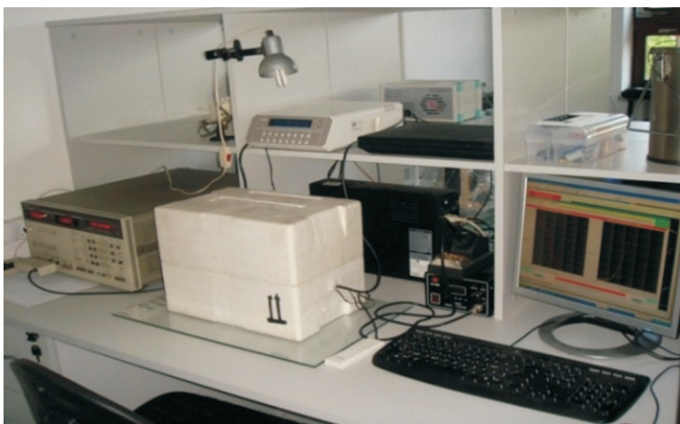
Rys. 3. Stanowisko do badań w spektroskopii dielektrycznej
