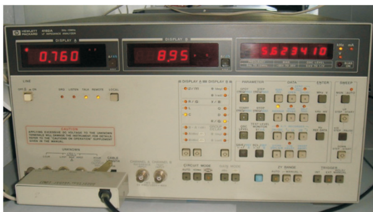
Rys. 1. Analizator impedancji HP 4192A firmy Hewlett Packard
