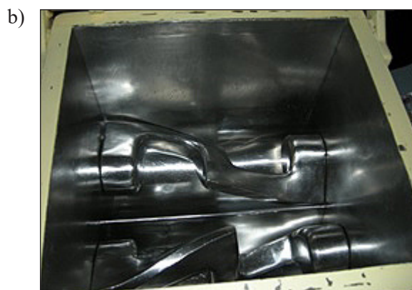
Rys. 4. Mieszalnik dwuwałowy z mieszadłem typu Z: a – widok ogólny, b – wnętrze mieszalnika
