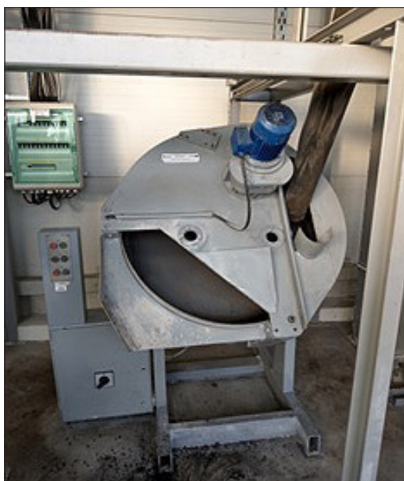
Rys. 3. Granulator talerzowy typ TR 10-0,3-1,5 (producent: Eirich GmbH)
