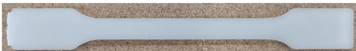
Rys. 1. Uniwersalna kształtka badawcza zgodna z normą PN-EN ISO 3167:2014 (opracowanie własne)
