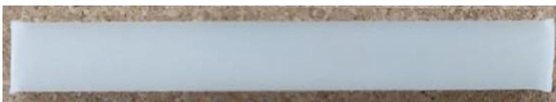
Rys. 2. Próbką przeznaczona do badań udarności (opracowanie własne) Fig. 2. Impact test sample (own study)
