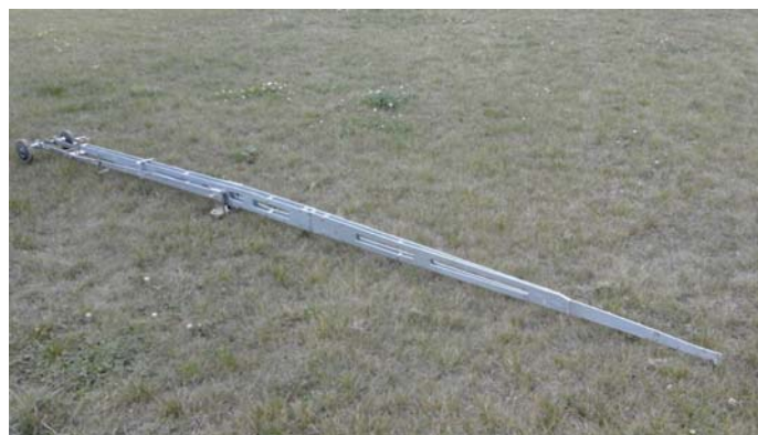
Fot. 1. Typowa belka Benkelmana
