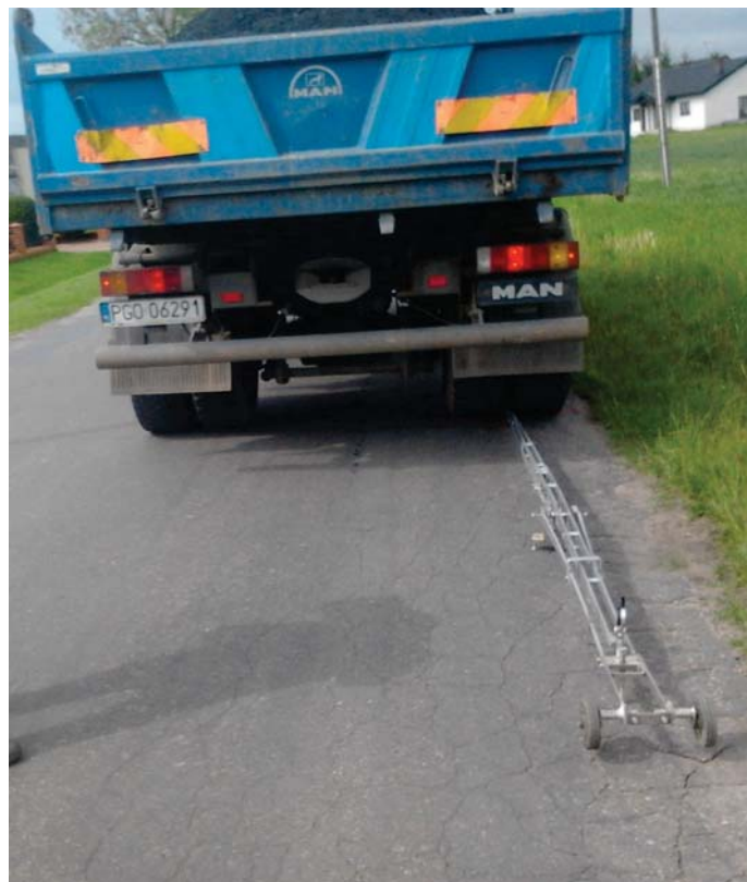
Fot. 2. Pomiar ugięć przy zastosowaniu belki Benkelmana
