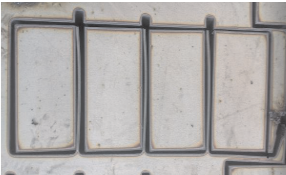
Rys. 4. Przykład linii cięcia łukiem plazmowym z wydłużonym wyjściem
