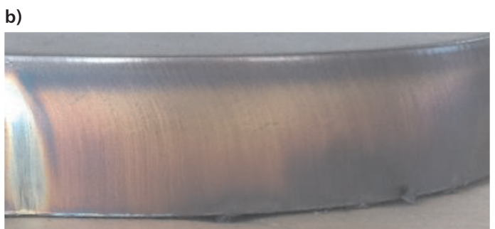
Rys. 10. Widoczna strefa wpływu ciepła dla elementu ze stali nierdzewnej AISI 1.4571
