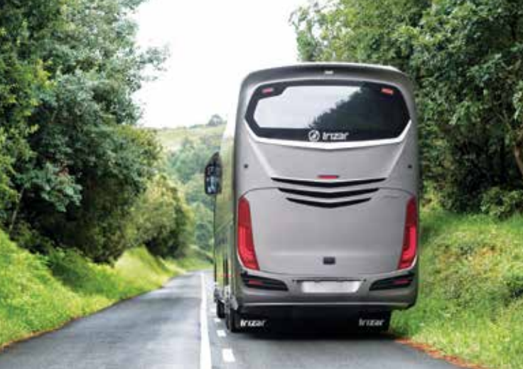
Tylna ściana z dużymi, charakterystycznymi otworami wlotowymi powietrza chłodzącego jednostkę napędową
