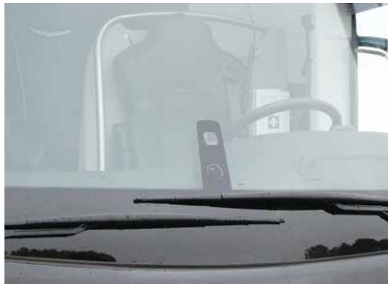
Kamera systemu LDW zamontowano tuż ponad deską rozdzielczą
