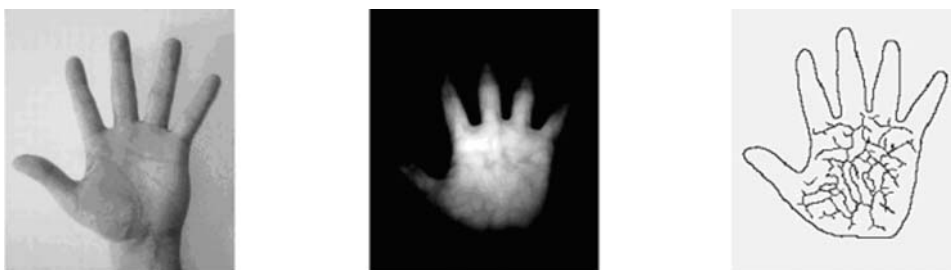
(a) obraz z kamery mono (b) obraz termowizyjny (c) naczynia krwionośne Rys. 3.6. Sekwencja pomiarowa i wynik analizy z wykorzystaniem kamery termowizyjnej [19]
