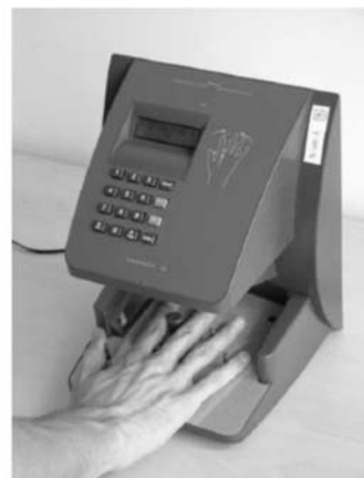
Rys. 3.4. Przykłady urządzeń (Handarunch 1000 [www.timeclockplus.com] i HandKey I [16] firmy Recogniton Systems Inc.) do ściśle określonych warunków pomiaru dłoni
