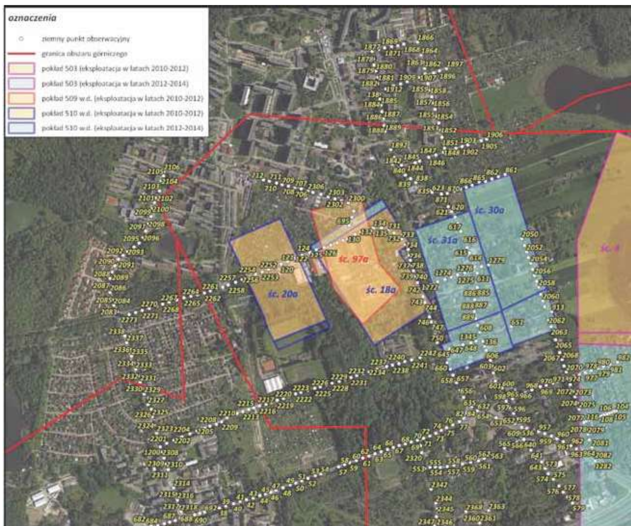
Rys. 1. Sieć obserwacyjna i zakres eksploatacji górniczej prowadzonej w latach 2010-2014 (ortofotomapa z 2014 r.) Fig. 1. Observation network and the reach of underground mining during 2010-2014 (orthophotomapa, 2014)
