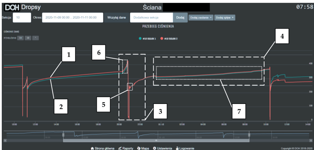
Rys. 11. Przebieg pracy sekcji zmechanizowanej obudowy ścianowej: 1 – stojak lewy, 2 – stojak prawy, 3 – czas związany z cyklem rabowania, przestawiania oraz rozparcia, 4 – monitorowanie rozparcia sekcji w ścianie 5 – podporność wstępna, 6 – podporność nominalna, 7 – podporność robocza
