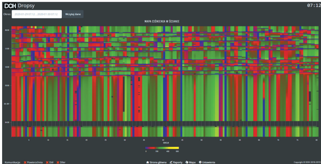
Rys. 10. Mapa rozkładu ciśnienia sekcji zmechanizowanej obudowy ścianowej
