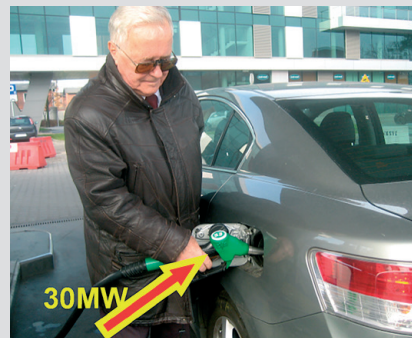
Fot. 3. Moc strumienia paliwa przy tankowaniu
