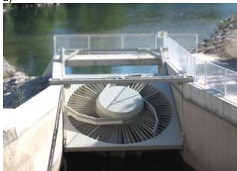
Fot. 1. Turbiny stosowane w małych elektrowniach wodnych: a) VHL, b) ślimakowa; źródło: VLA [niedatowane], Dobra Energia [niedatowane]
