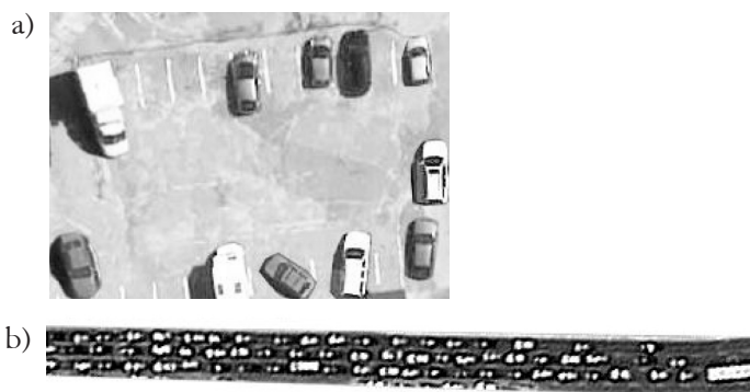
Rys. 4 a. Zdjęcie lotnicze powierzchni parkingowej (1 punkt = 0,1m); b. zdjęcie satelitarne (1 punkt = 0,4 m)
