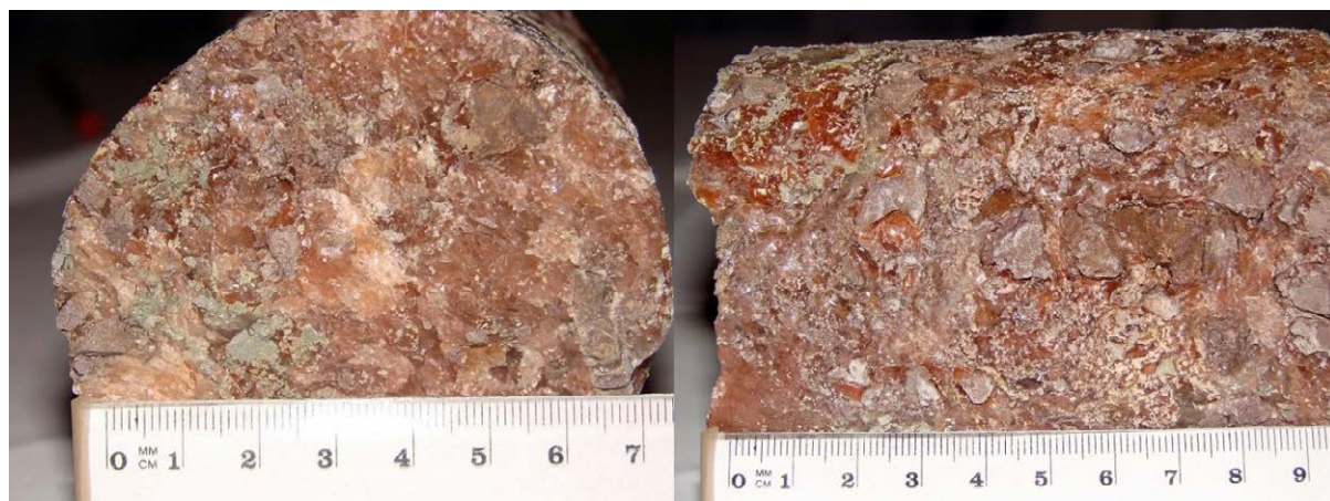
Ryc. 5. Zuber czerwony; głęń. 1000 m (widok ogólny). Widoczne pomarańczowe ziarna halitu oraz czerwobrunatne i szarozielone skupienia ilaste. Próbką M-34/1000.
