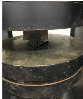
Fig. 5. Indirect tensile strength test Rys. 5. Badanie wytrzymałości na rozciąganie pośrednie
