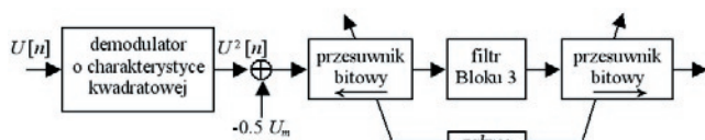
Rys.9 Schemat blokowy realizacji filtra Bloku 3 w arytmetyce stałoprzecinkowej w mierniku migotania światła. U_m - amplituda sygnału 50 Hz Fig.9 Block diagram of Block 3 filter realization in fixed point arithmetic in Flicker Meter, U_m - amplitude of 50 Hz signal
