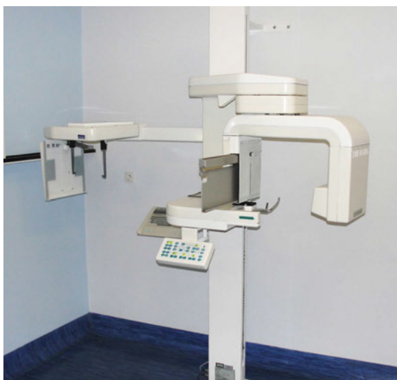
Fot. 7 Analogowy aparat pantomograficzny z przystawką cefalometryczną; ustawiony w trybie cefalometrycznym – wiązka pierwotna przechodzi w części przez klin aluminiowy umieszczony na brzegu wózka kasety Źródło: Zbiory własne.
