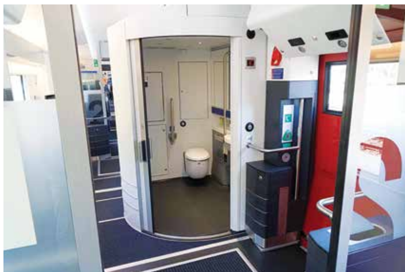
Szerokie wejście do toalety umożliwia wjazd osobie na wózku inwalidzkim
