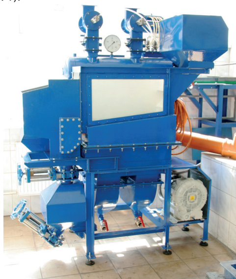
Rys. 1 Stanowisko doświadczalne osadzarki laboratoryjnej
