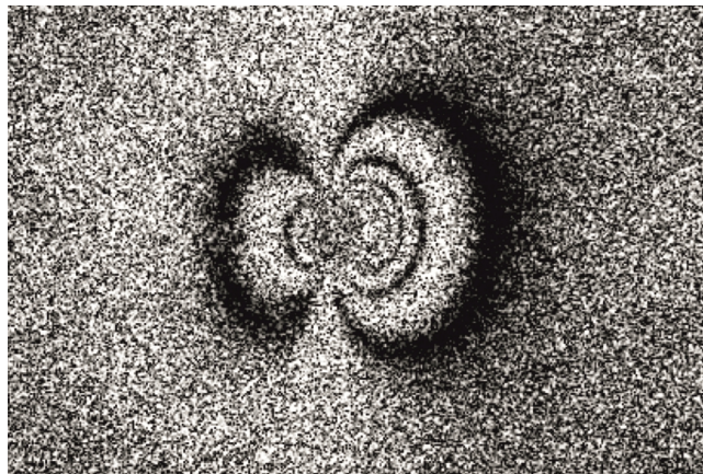
Rys. 5. Przykładowa mapa z prążkami interferencyjnymi i efektem plamkowania Fig. 5. Sample map of interference fringes and the effect of the speckling
