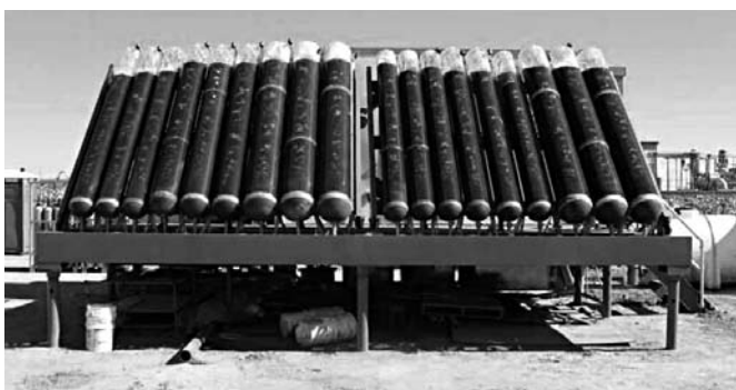
Rys. 8. Hodowla alg w fotobioreaktorach w Arizonie (USA)
