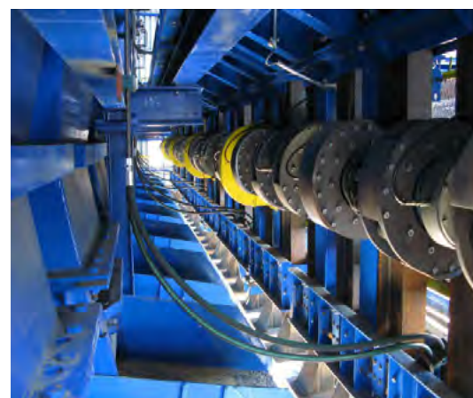
Rys.1. Wprowadzanie ubitego wsadu do komory koksowniczej (a), zestaw ubijający na jednej z krajowych koksowni (b). 1- maszyn naboju, 2- wsadnica, 3 – wieża węglowa, 4- ubijaki, 5- nabój węglowy, 6- wóz stropowy, 7 –wóz przelotowy, 8- wieża gaśnicza
