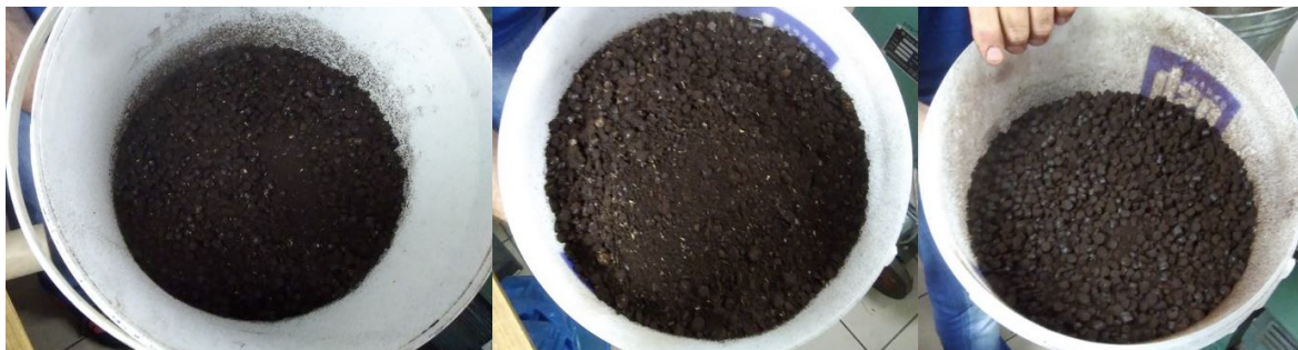
Rys. 6. Wyniki peletyzacji – wraz z kolejnymi powtórzeniami procesu widocznie zwiększająca się ilość uformowanych peletów
