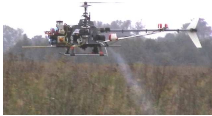
Fot 2. Wytwarzanie dymu wizualizujące kierunek śladu wirnika
