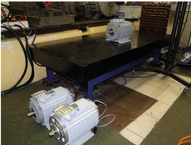
Rys. 12. Badania jednej z maszyn PM na stole wibracyjnym
