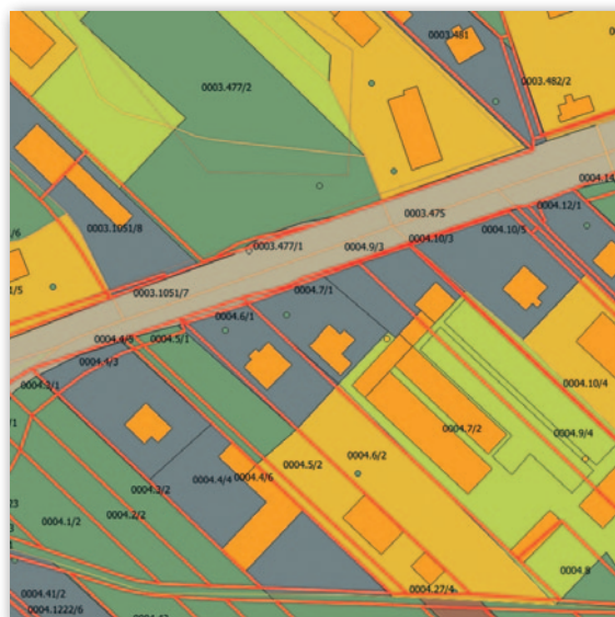
Rys. 3. Fragment danych BDOT10k wraz z działkami ewidencyjnymi (skala 1:1000)
