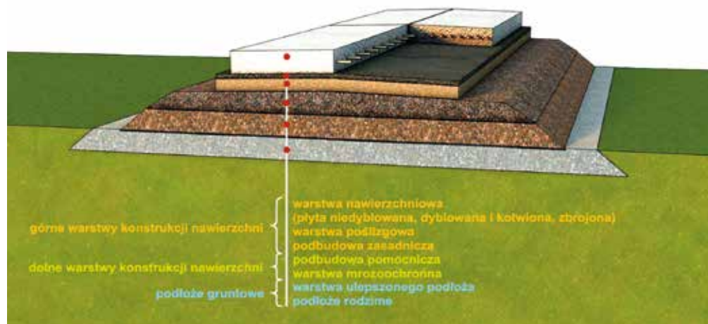
Rys. 2. Schemat warstw konstrukcji nawierzchni sztywnych oraz warstwy ulepszanego podłoża
