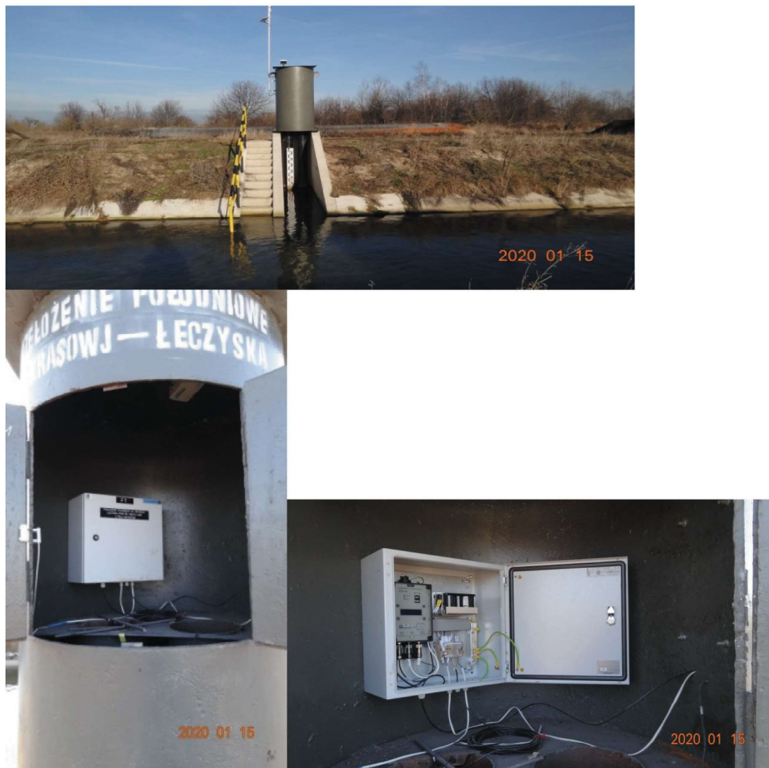
Rys 3. Limnigraf na rzece Krasówce - widok ogólny z zastosowanym systemem rejestracji (foto Stobiecki) Fig. 3. Limnigraf on the Krasówka river - general view with the registration system used (photo Stobiecki)
