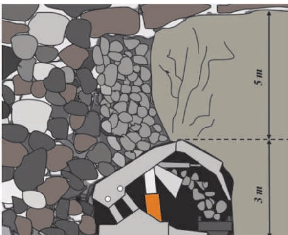
Rys. 9. System podbierkowy ścianowy stosowany w kopalni lignitu Soma Fig. 9. Longwall Top Caving used in lignite Soma Mine
