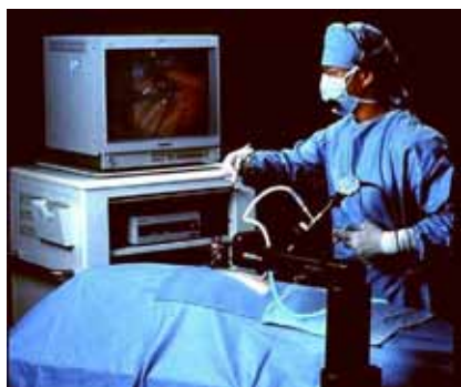
Rys. 2. Operacja z zastosowaniem robota AESOP do operacji małoinwazyjnych narzędziami laparoskopowymi.
