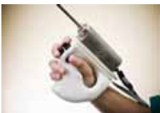
Rys. 3. Elementy zrobotyzowanych stanowisk operacyjnych FRK Zabrze: Robot Robin Heart Vision (u góry), zrobotyzowane narzędzie do obsługi ręcznej lub obsługi przez robota (z lewej)
