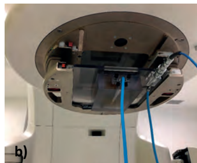
Ryc. 5a) Cylindryczna komora jonizacyjna typu Farmer 30013 (PTW); b) komora pomiarowa umieszczonej w płytce wykonanej z PMMA i umieszczonej w uchwycie kolimatora aparatu
