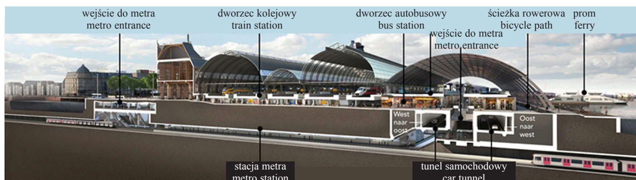
Il. 2. Przebudowa dworca Amsterdam Centraal (źródło: Gemeente Amsterdam, www.amsterdam.nl , data dostępu: 24.07.2014)
