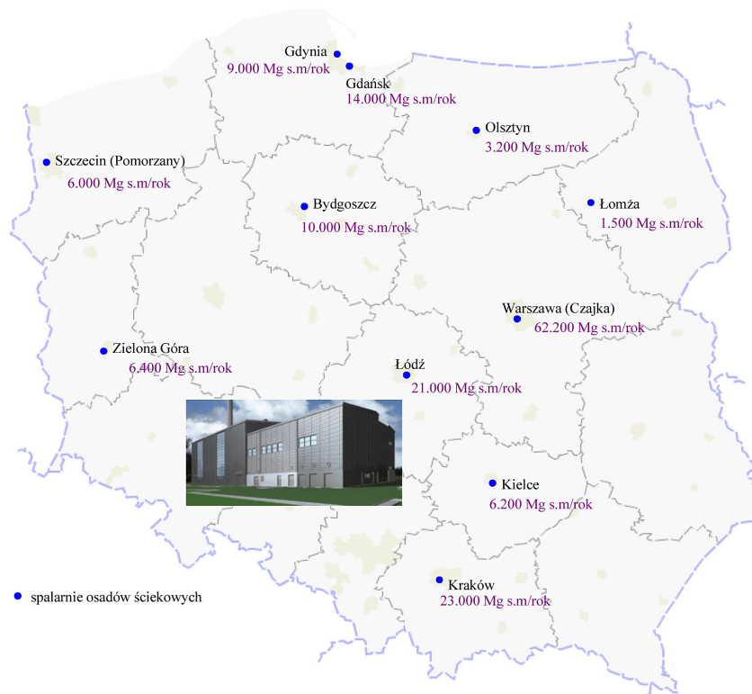
Rys. 3. Lokalizacja monospalarni komunalnych osadów ściekowych
