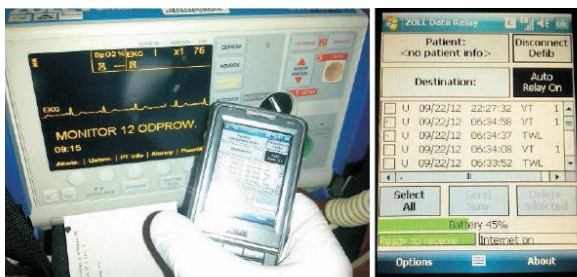
Fot. 1 Zestaw do transmisji EKG, używany przez zespoły ratownictwa medycznego Źródło: [10].
