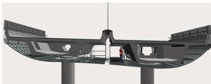
Fot. 15. Przekrój poszerzonego mostu Drammen [2]
