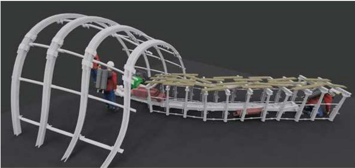
Rys. 1. Model 3D wyrobiska ratowniczego - dla akcji ratowniczej związanej z zawalem wyrobiska [4]
