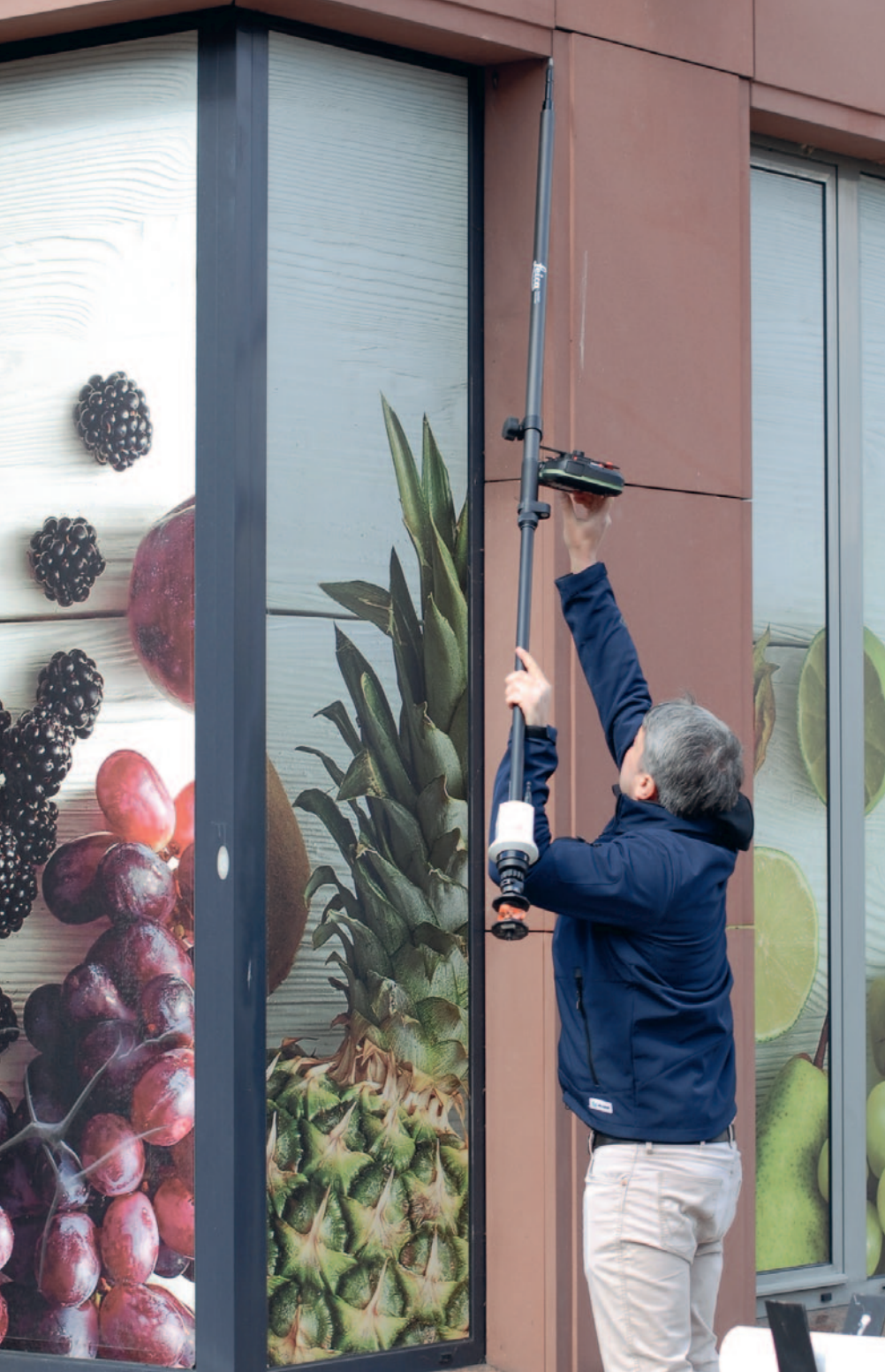
Urządzenie umożliwia także pomiar z odwróconą tyczką
