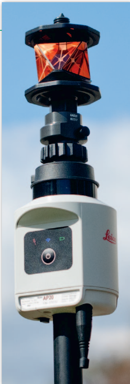
AutoPole można zamontować zarówno na szczycie tyczki...
