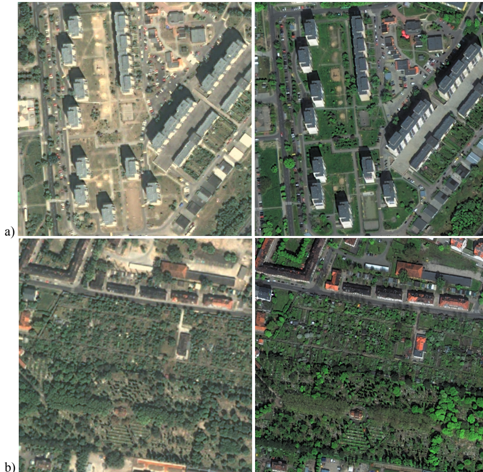
Rys. 5. Porównanie wyostrzonych kompozycji barwnych (kanały widzialne) obrazów QB-2 i WV-2 osiedla mieszkaniowego z infrastrukturą drogową (a) oraz ogrodów działkowych i cmentarza (b). Szczególnie widoczne jest zróżnicowanie barwne roślinności (opracowanie własne)
