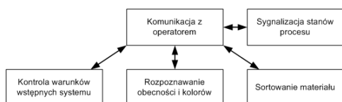
Rys. 4. Struktura funkcjonalna systemu sterowania [opracowanie własne] Fig. 4. The functional structure of the control system [the authors' elaboration]
