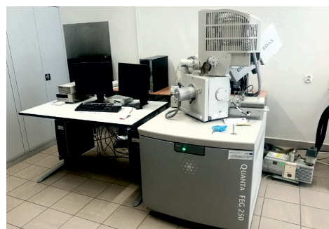
Rys. 2. Widok skaningowego mikroskopu elektronowego z analizatorem EDS Fig. 2. The view of scanning electron microscope with the EDS analyser
