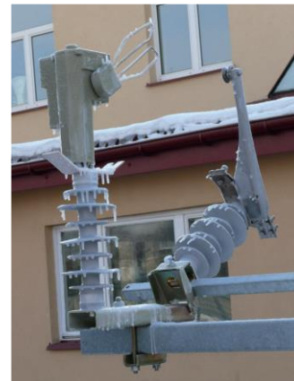
Rys.9 Rozłącznik podczas prób z oblodzeniem [9]
