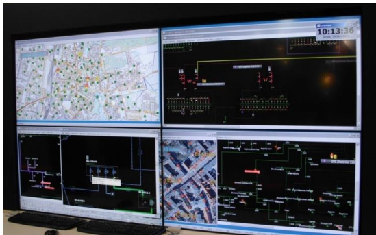
Rys.10 Wizualizacja stanu sieci elektroenergetycznej za pomocą systemu WindEx [10]
