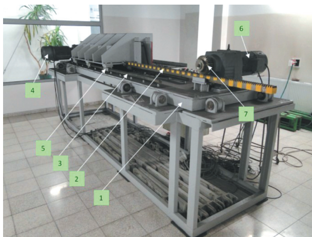
Rys. 4. Stanowisko do badań procesu ładowania: a) widok stanowiska badawczego od strony silnika posuwu i listwy; b) widok od strony organu: 1 – podstawa stanowiska, 2 – listwa zębata, 3 – prowadnice, 4 – silnik napędu organu, 5 – ślizgi, 6 – silnik napędu posuwu, 7 – koło zębate, 8 – organ urabiający, 9 – rama przesuwna
