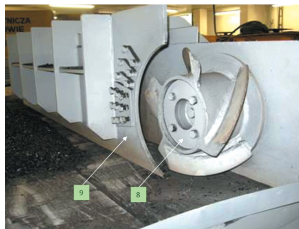
Rys. 4. Stanowisko do badań procesu ładowania: a) widok stanowiska badawczego od strony silnika posuwu i listwy; b) widok od strony organu: 1 – podstawa stanowiska, 2 – listwa zębata, 3 – prowadnice, 4 – silnik napędu organu, 5 – ślizgi, 6 – silnik napędu posuwu, 7 – koło zębate, 8 – organ urabiający, 9 – rama przesuwna
