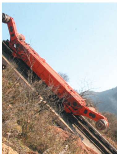
Rys. 3. Klasyczny kombajn ścianowy do stromych pokładów na poligonie firmy Beijing HOT Mining Tech [5]
