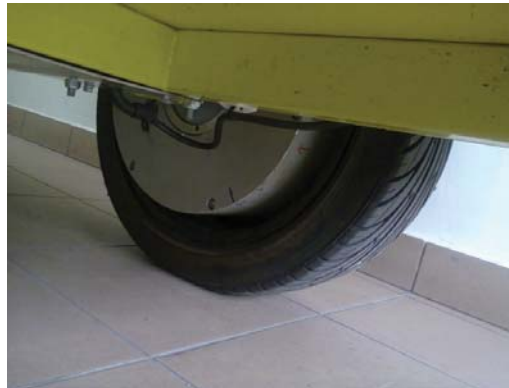
Rys. 7. Silnik z felgą i oponą zamontowany na ramie pojazdu (widok od strony mocowania do podwozia pojazdu)
