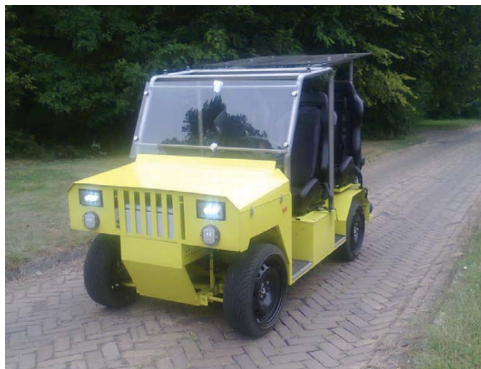
Rys. 1. Model eksperymentalny pojazdu uniwersalnego o napędzie elektrycznym
