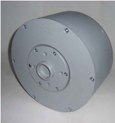
Rys. 4. Kompletny silnik (widok od strony mocowania koła pojazdu)
