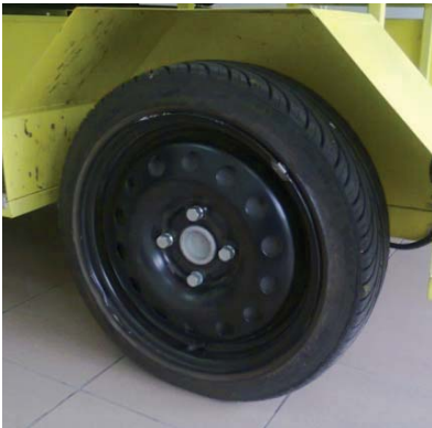
Rys. 6. Silnik z felgą i oponą zamontowany na ramie pojazdu (widok od strony mocowania koła pojazdu)
