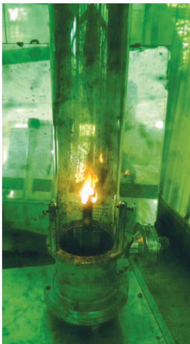
Fot. 1. Badanie odporności na palenie kompozycji elastomerowej (fot. własna)
