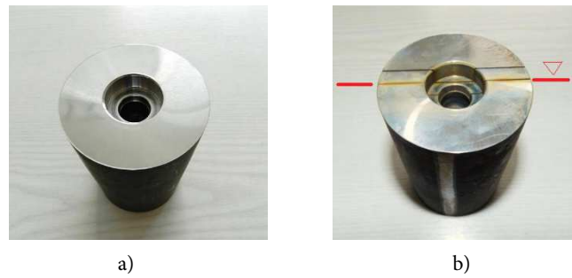
Rys. 10. Matryca Putanker 2,5 T (a) z zaznaczonym miejscem pobrania próbki metalograficznej (b) Fig. 10. Putanker 2.5 T die (a) with marked location of metallographic specimen collection (b)
