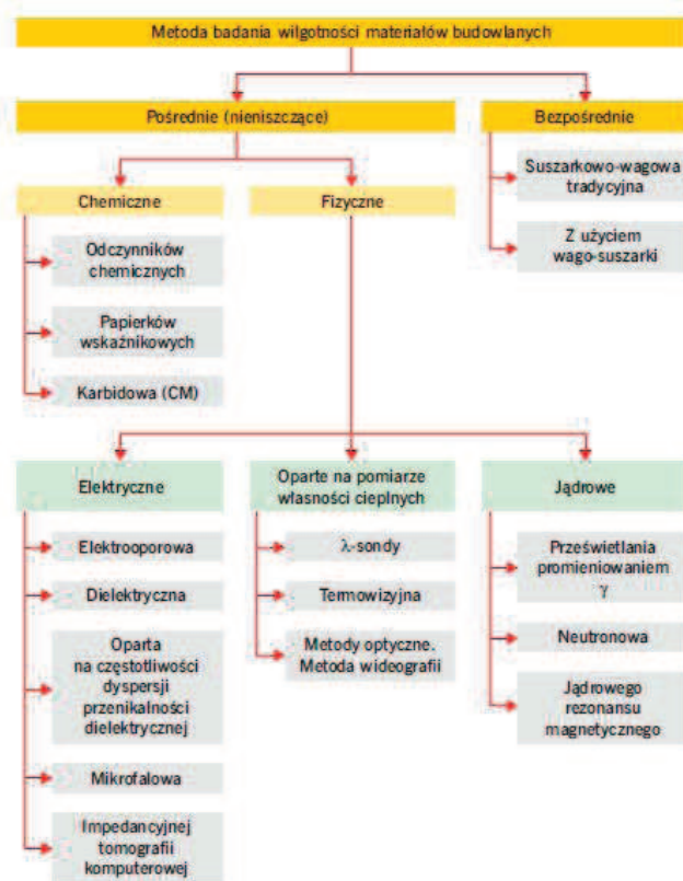
Rys. 1. Podział metod badania wilgotności materiałów budowlanych [1]
