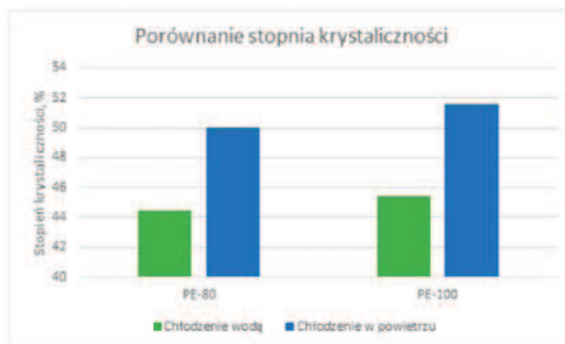
Rys. 7. Porównanie stopnia krystaliczności wytłoczn (chłodzonych wodą i bez chłodzenia)
