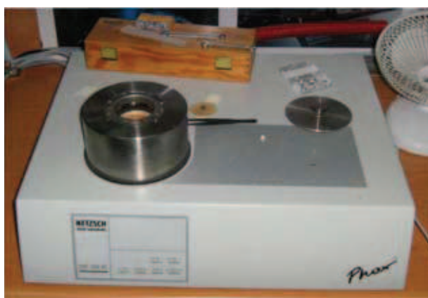
Rys. 4. Kalorymetr Phox DSC 200 PC firmy Netzsch
