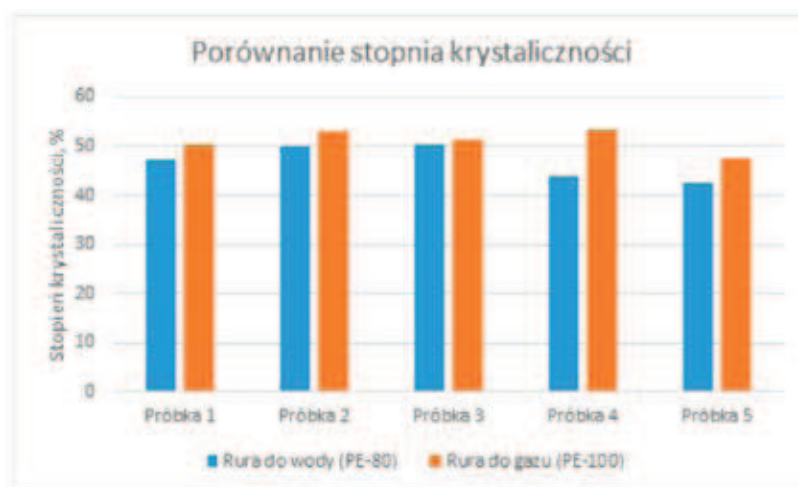
Rys. 6. Porównanie stopnia krystaliczności przewodów rurowych.
