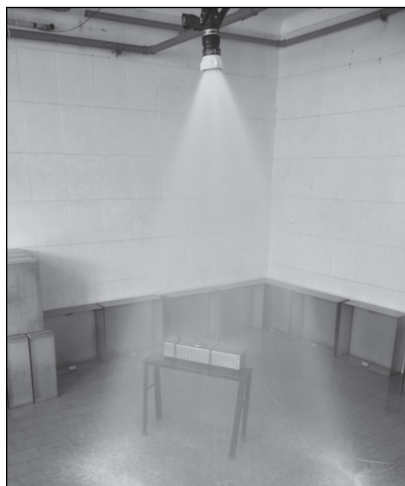
Rys. 3. Strumień generowany przez prądownicę TurboJet 52
