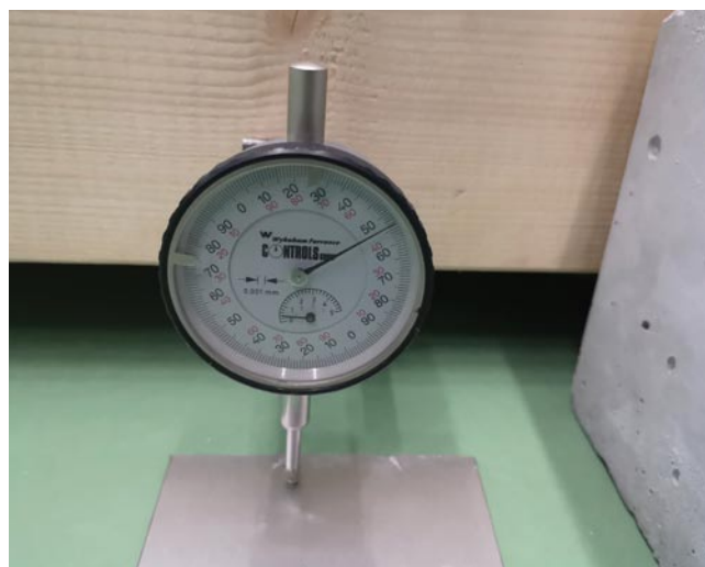
Rys. 16. Pomiar zmian ugięć sprężonych belek w czasie za pomocą czujnika zegarowego
