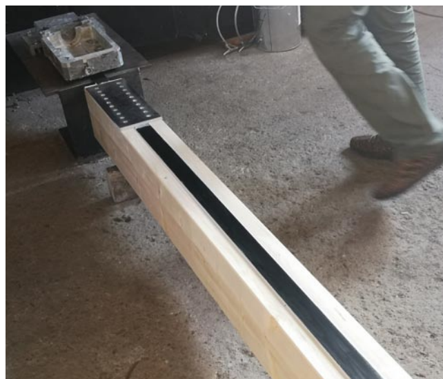
Rys. 15. Belka z przyklejoną napiętą taśmą oraz przykręconymi blachami kotwiącymi
