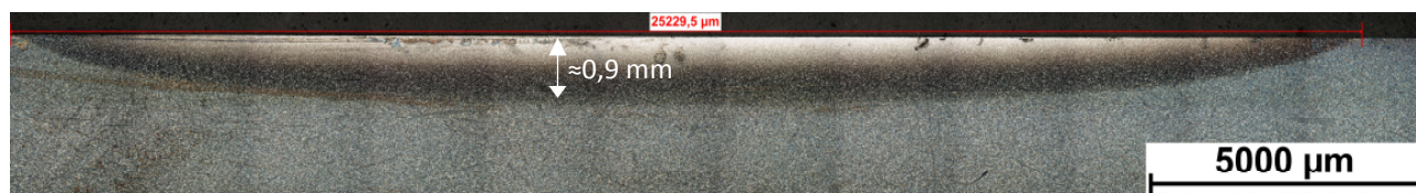
Rys. 4. Warstwa utwardzona podczas hartowania stali laserem diodowym
