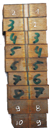
Rys. 5. Próbki z widocznymi odległościami między ścieżkami hartowanymi laserem i wartości tych odległości
